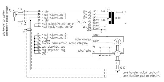
Attention: connect the motor case with the amplifier's power ground Attention: raccordez la carcasse du moteur à la masse de puissance du variateur
