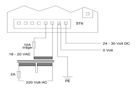
Die Einspeisung beim 24-Volt Regler kann **entweder** über einen Trafo erfolgen **oder** mit einem direkten Anschluß einer Gleichspannung ( z.B. aus einer Batterie ). Der 0V-Anschluß des Reglers sollte zentral im Schaltschrank geerdet werden.
