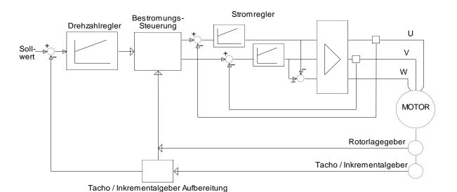
Der Drehzahlregelkreis besteht aus Drehzahlregler mit unterlagertem Stromregelkreis und Drehzahlerfassung. Der Drehzahlsollwert wird von außen vorgegeben (Poti, NC o.ä.).
