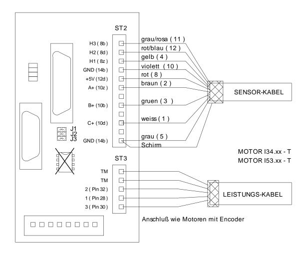
Es gelten entweder die Farben oder, bei nummerierten Leitungen, die in den Klammern vermerkten Adernummern ( entsprechen den Pinnummern der Rundsteckverbinder ). Auf der Rückwandplatine müssen die Brücken J1,J2 und J3 geschlossen sein, und das IC1 muß entfernt sein.
