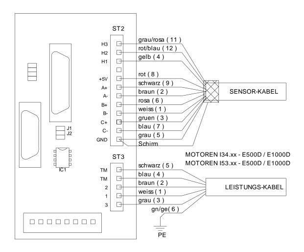
Es gelten entweder die Farben oder, bei nummerierten Leitungen, die in den Klammern vermerkten Adernummern ( entsprechen den Pinnummern der Rundsteckverbinder ). Auf der Rückwandplatine müssen die Brücken J1 und J2 entfernt sein und das IC1 muß bestückt sein.
