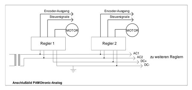
Das Bild zeigt die prinzipielle Verdrahtung eines Systems mit den Analog-Reglern 120/6-A und 24/7-A. Der Anschluß erfolgt komplett auf der Rückwandplatine des Reglers. Die Anschlüße der Stromversorgung und der Motoranschluß erfolgen auf Schraubklemmen.
