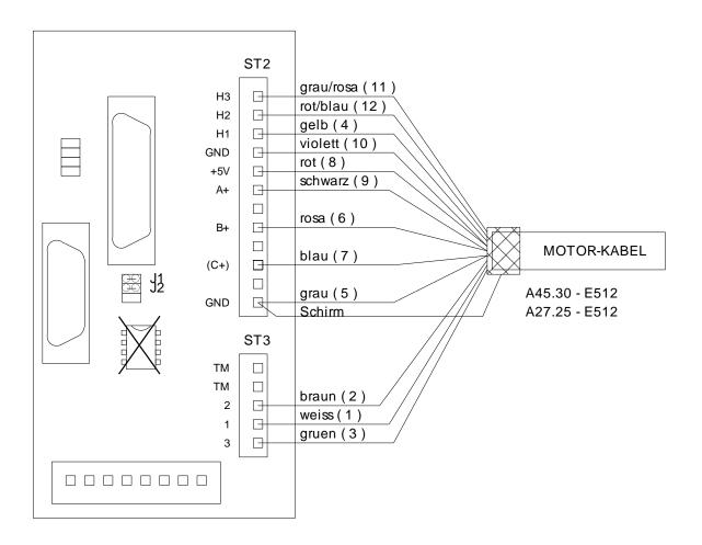
Es gelten entweder die Farben oder, bei nummerierten Leitungen, die in den Klammern vermerkten Adernummern ( entsprechen den Pinnummern des Rundsteckverbinders ).
