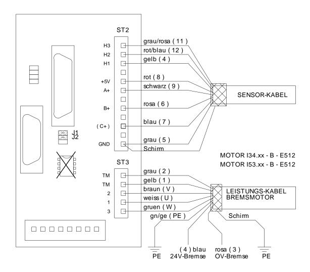
Es gelten entweder die Farben oder, bei nummerierten Leitungen, die in den Klammern vermerkten Adernummern ( entsprechen den Pinnummern der Rundsteckverbinder ). Auf der Rückwandplatine müssen die Brücken J1 und J2 geschlossen sein, und das IC1 muß entfernt sein.
