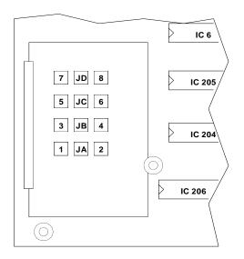
Die Einstellung erfolgt mit den Lötbrücken JA .. JD in 10 kHz Schritten mit folgender Wertung:
