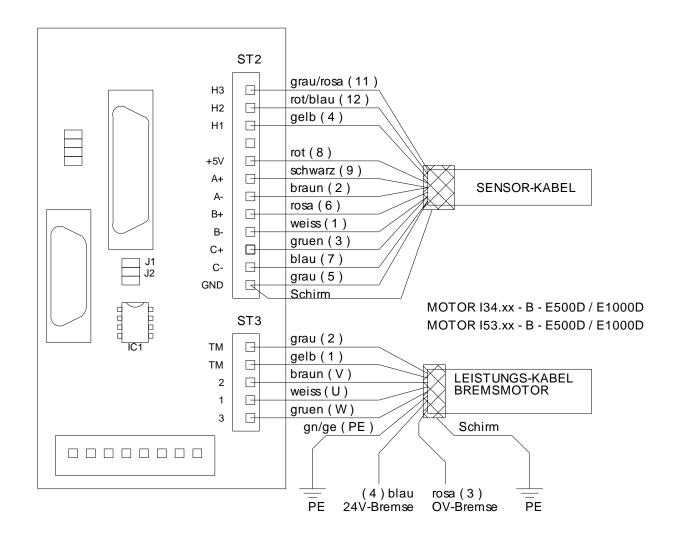
Es gelten entweder die Farben oder, bei nummerierten Leitungen, die in den Klammern vermerkten Adernummern ( entsprechen den Pinnummern /Pinbezeichnungen der Rundsteckverbinder ). Auf der Rückwandplatine müssen die Brücken J1 und J2 entfernt sein und das IC1 muß bestückt sein.
