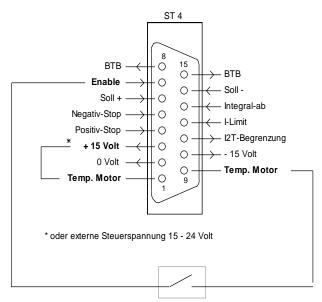
Der PTC-Widerstand wird in Reihe mit der Enable-Steuerleitung geschaltet.
