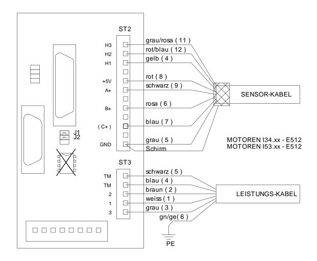
Es gelten entweder die Farben oder, bei nummerierten Leitungen, die in den Klammern vermerkten Adernummern ( entsprechen den Pinnummern der Rundsteckverbinder ). Auf der Rückwandplatine müssen die Brücken J1 und J2 geschlossen sein, und das IC1 muß entfernt sein.
