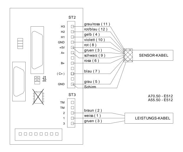
Es gelten entweder die Farben oder, bei nummerierten Leitungen, die in den Klammern vermerkten Adernummern ( entsprechen den Pinnummern der Rundsteckverbinder ).
