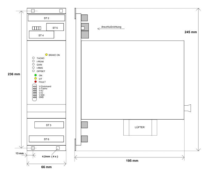
Der Anschluß der Motoren, Steuersignale und Leistungseinspeisung erfolgt auf den Steckern ST2..ST6.
