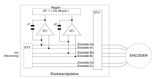
Die Motoren der PAMOdyn-Serie besitzen entweder Encoder mit TTL-Ausgängen oder mit eingebauten Leitungstreibern ( ...3486-er Typen, z.B. von National, Motorola mit 5-Volt Pegel ) nach RS422-Norm zur sicheren Übertragung, auch bei sehr langen Leitungen.
