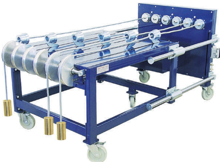
Bild 3: Matkke bietet Kabelprüfmaschinen für alle Prüfaufgaben an: Flextests, Wechselbiegetests, Torsionstestmaschinen (Bild) und Schleppkettentest.
