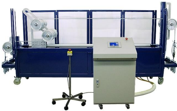
Mattke Flextestmaschine für 6 Kabel
